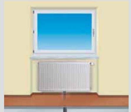
Udubljenje u zidu za radijator je na sredini radijatora
